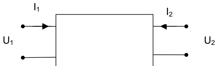
Obr. 4.11: Tranzistor jako čtyřpól
